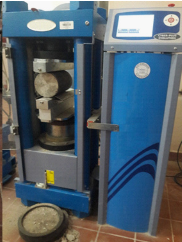
Figura 13. Equipo para ensayo de tracción indirecta de laboratorio (en funcionamiento)
